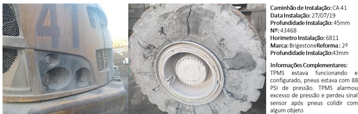
Figura 3 - Exemplo do relato de acidentes com pneus realizado pela equipe de manutenção Fonte: Autores (2022).
